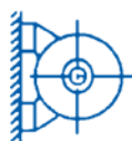
IM B6 (IM 1 051) Wellenende horizontal Füße auf AS gesehen links Befestigung an der Wand
