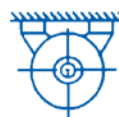
IM B8 (IM 1 071) Wellenende horizontal Füße auf AS gesehen oben Befestigung an der Decke
